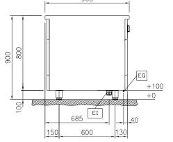
Electrical inlet (power) EQ Equipotential screw
